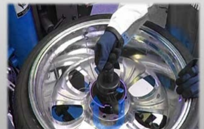
Sistema de fijación autocentrante con enganche rápido auto-click
