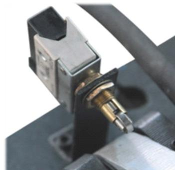
Control de altura con sensor de final de carrera
